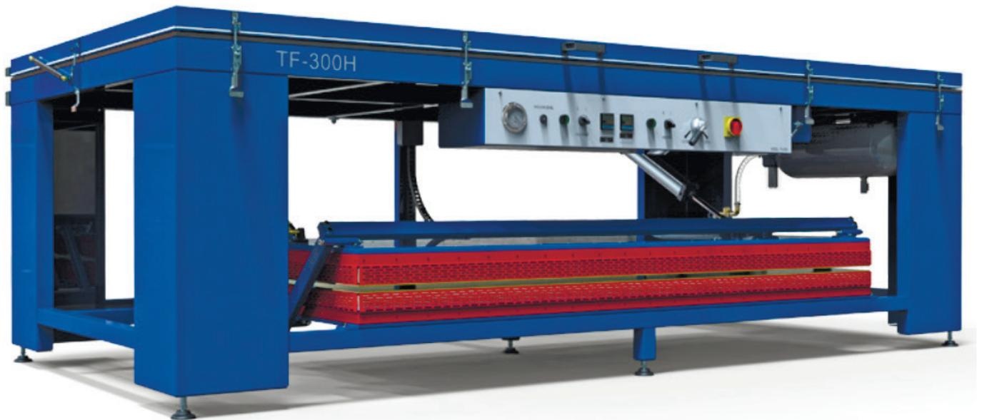
Vakuum-Membranpressen TF-Serie sind speziell für Vorwärmung und Gestaltung der feste Oberflächenmaterialien (Corian, Hi Macs, Staron, Hanex, Kerrock u.a.), sowie für Acryl Material und thermoplastischen bilden. TF Serie Vakuumpressen sind kombinierte Lösung einschließlich Funktionen von zwei separaten Maschinen: Vakuum-Presse und Vorheizen Backofen, und diese stark erhöht Funktionalität der Vakuum-Presse. Die Modellreihe bestehen drei Modelle: TF-160H, TF-300H und TF-350H.
